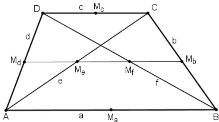
In dem Trapez müssen die Mittelpunkte  $M_b$ ,  $M_d$ ,  $M_e$  und  $M_f$  der Seiten [BC] und [AD] sowie der Diagonalen [AC] und [BD] auf einer Geraden liegen, nämlich der Mittelparallelen  $[M_b M_d]$  des Trapezes.
