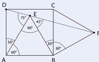
Da die Innenwinkel im Quadrat alle  $90^\circ$  groß sind, ergibt sich  $\angle EAD = 90^\circ - 60^\circ = 30^\circ$ .
